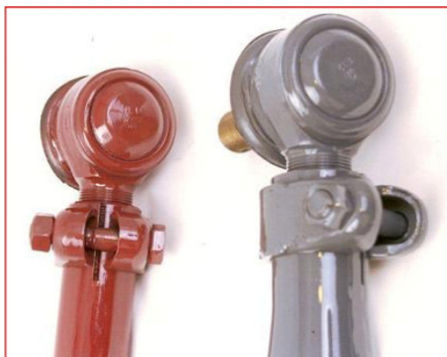
Fig. 4 – Vista parcial das barras de direção com seus diâmetros reduzidos
